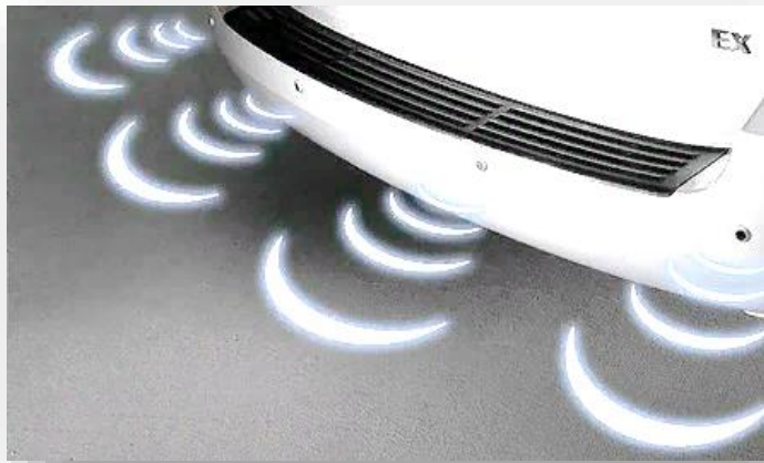
Рис. 17 Датчики-эхолоты парковки в заднем бампере
