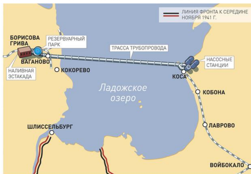
СХЕМА ТРУБОПРОВОДА ЧЕРЕЗ ЛАДОЖСКОЕ ОЗЕРО. 1942 ГОД
