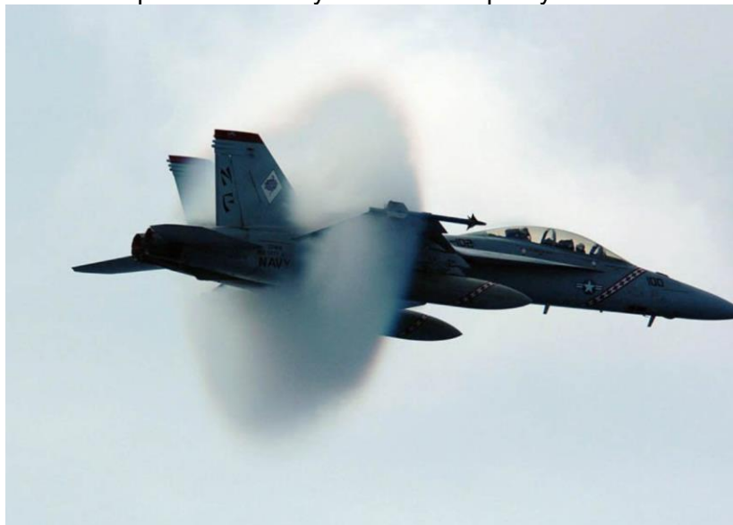
Рис. 1 Образование конуса ... на сверхзвуке
